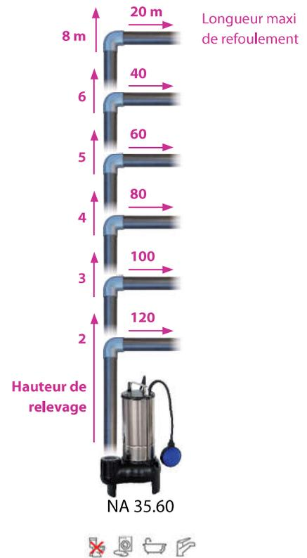
Hauteur et longueur calculée sur la base d'une tuyauterie en sortie de 40mm extérieur minimum
