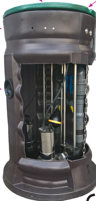
Colonne de refoulement avec 2 pieds d'assise, 2 clapets à boule PVC Socla, 2 vannes, 2 pompes roue Vortex
