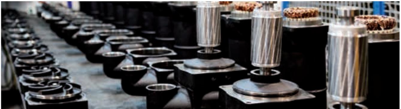
**MR Pompes** vous présente ci-dessous sa gamme de pompes industrielles de construction fonte. L'étanchéité est garantie par un double joint mécanique à l'intérieur d'une chambre à huile. Il est possible d'avoir, en option, des thermo sondes pour la surcharge moteur et une détection de l'eau dans l'huile pour préserver la longévité du moteur.
