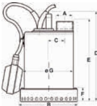
Pompes submersibles à double enveloppe pour l'assèchement des eaux d'infiltration dans les garages, sous-sols et caves
