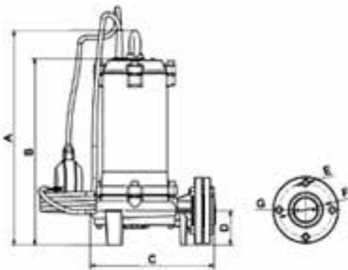
Avec une **roue dilacératrice en inox**, c'est une gamme idéale pour les eaux très chargées. Le broyage des matières en suspension permet de fluidifier l'effluent avant passage dans la turbine et assure un meilleur écoulement dans la canalisation de refoulement.
