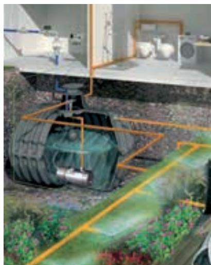
Remplissage, vidange et surpression (électropompe submersible)
