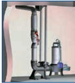
Les pieds d'assise facilitent les opérations de maintenance, en permettant de sortir la pompe sans vider la fosse. Le corps est en fonte, les joints en caoutchouc.
