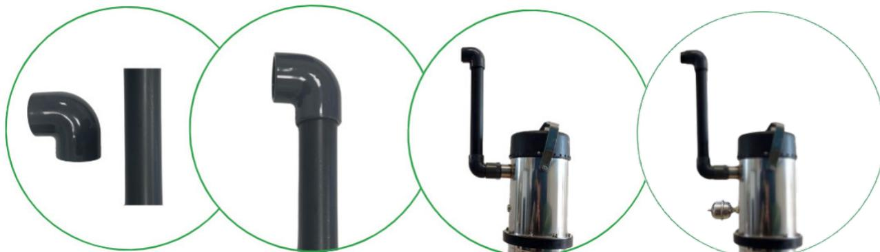
**4 :** Ensuite, munissez-vous du tube PVC Ø 40 et d'un coude 90°, les assembler et coller puis emboîter l'ensemble au niveau du coude déjà installé. Se munir du réservoir ACX 0.16 L et le visser au trou de remplissage de la pompe.
