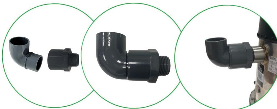
3 : Récupérer l'embout PVC fileté 1"1/4 et le coude 90° M/F afin de les assembler et coller. Puis visser l'ensemble à la sortie de la pompe (refoulement de la pompe en haut). Réaliser l'étanchéité des assemblages avec le PTFE fourni.
